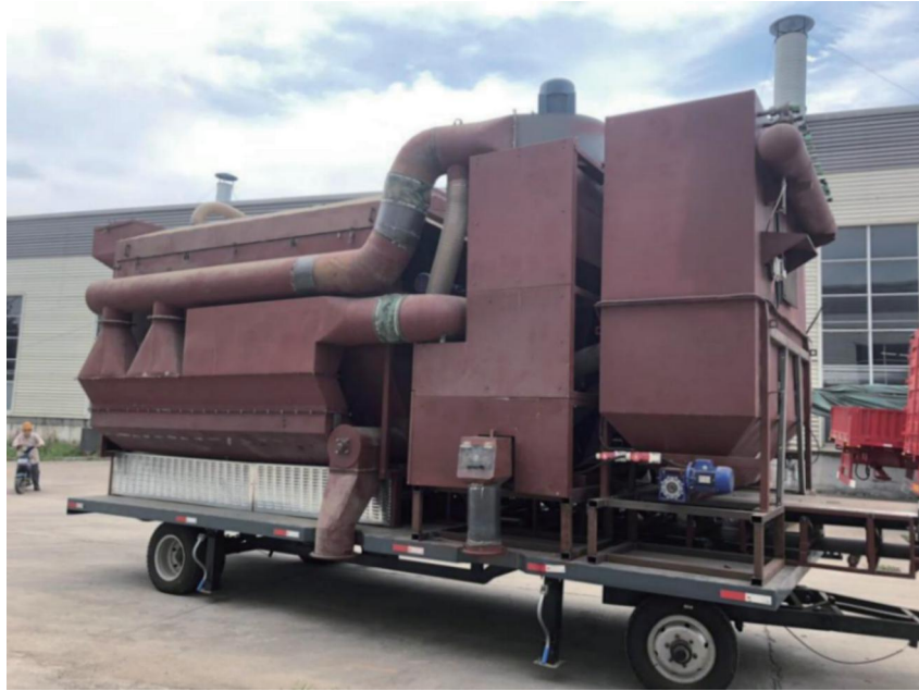
新型移动式高效环保组合式清理设备(样机)
