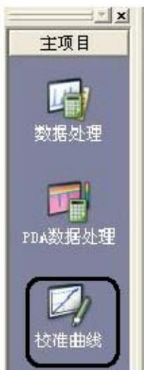
**2** 打开方法文件“外标曲线.qgm”，此时方法中校准曲线已自动生成。
