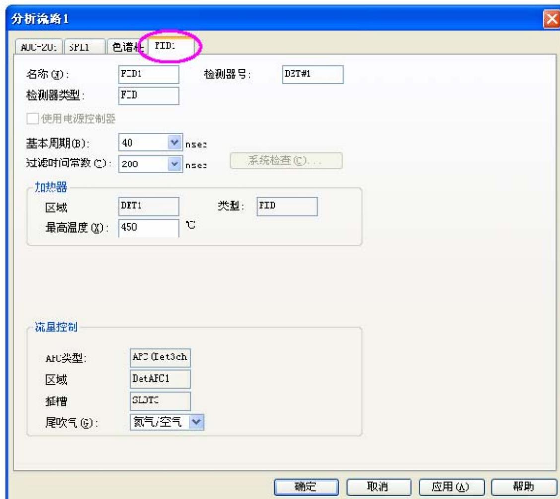
模块中各组件设定完毕，点击<系统配置>窗口的[确定]按键，将仪器配置参数传输给 GC。
