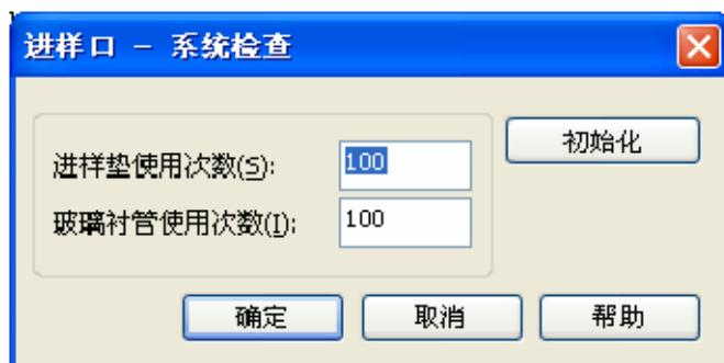
在这里可以设定进样垫和玻璃衬管的最大使用次数。默认值为 100。点击[确认]完成设定。
