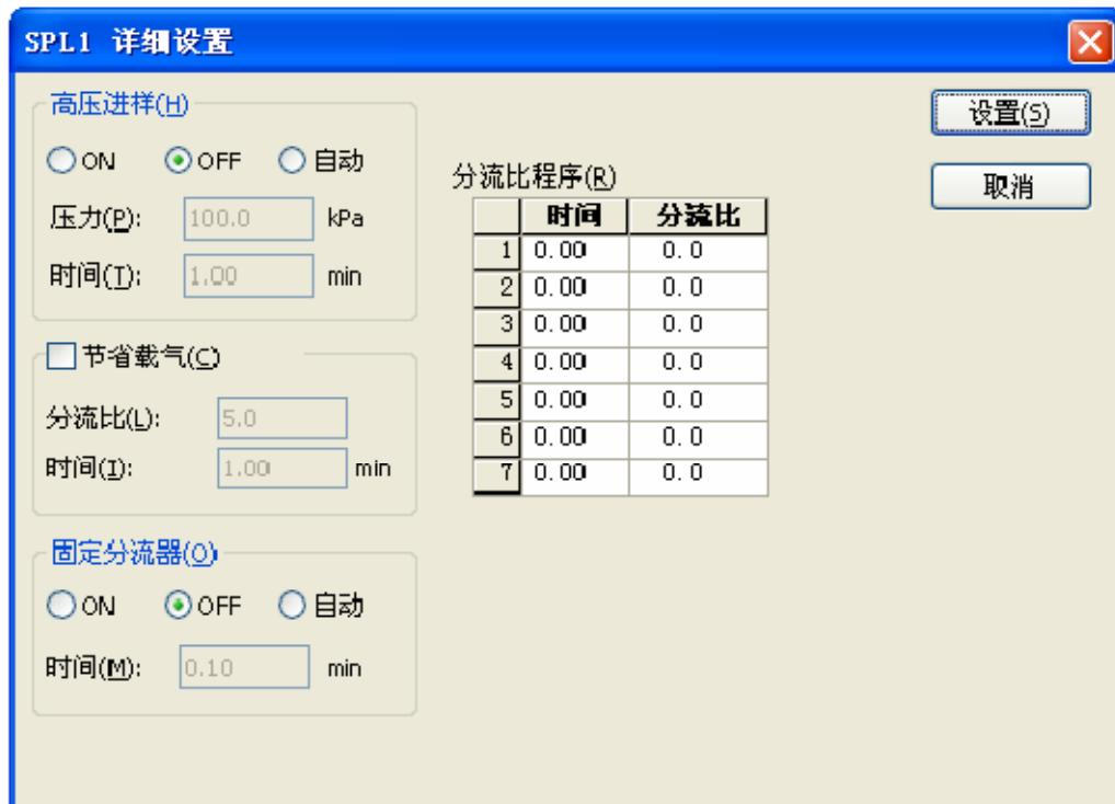
**高压进样：**当进样方式设为不分流时，可点击[自动]启用此功能。此时[压力]和[时间]激活。压力可根据需要进行设定。时间与不分流进样时间一致。
