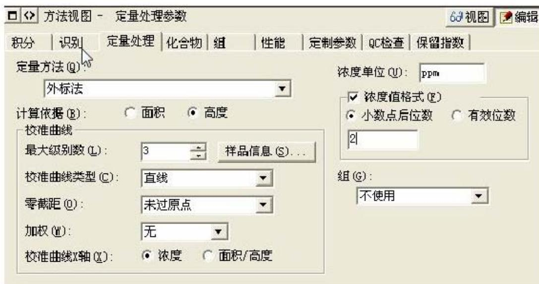
Lab solution 中有几种定量方法，例如内标法，必须在样品中添加内标化合物，或者外标法，不能将其加入样品。
