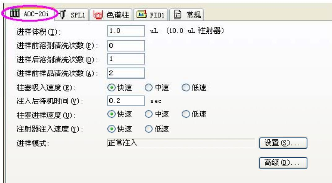
**进样体积:** 注入进样口的样品量。当使用 10 $\mu$ L 进样针时，一般进样 1~2 $\mu$ L，此处设为 1 $\mu$ L。(SPL 进样口最大允许进液体样 2 $\mu$ L)
