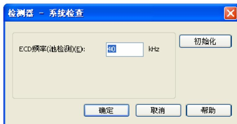
ECD 参数设定后，点击[确定]，在[系统配置]窗口中点击[确定]。仪器配置完成。
