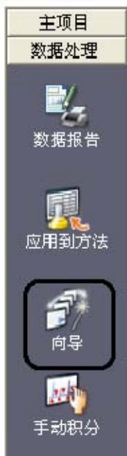
**2** 在向导窗口中，出现峰积分参数表，设置相关参数后，点击【下一步】。
