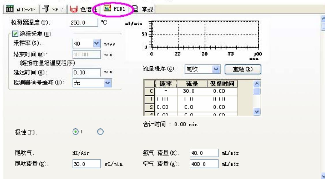
检测器温度：本例检测器温度设为 250°C，一般建议 FID 检测器温度设定 ≥250°C。
